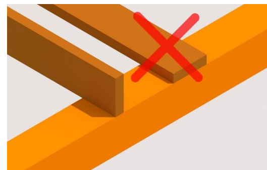
Fig. 24 – Întotdeauna grinzile de planșeu se vor monta cu latura cea mare pe verticală
