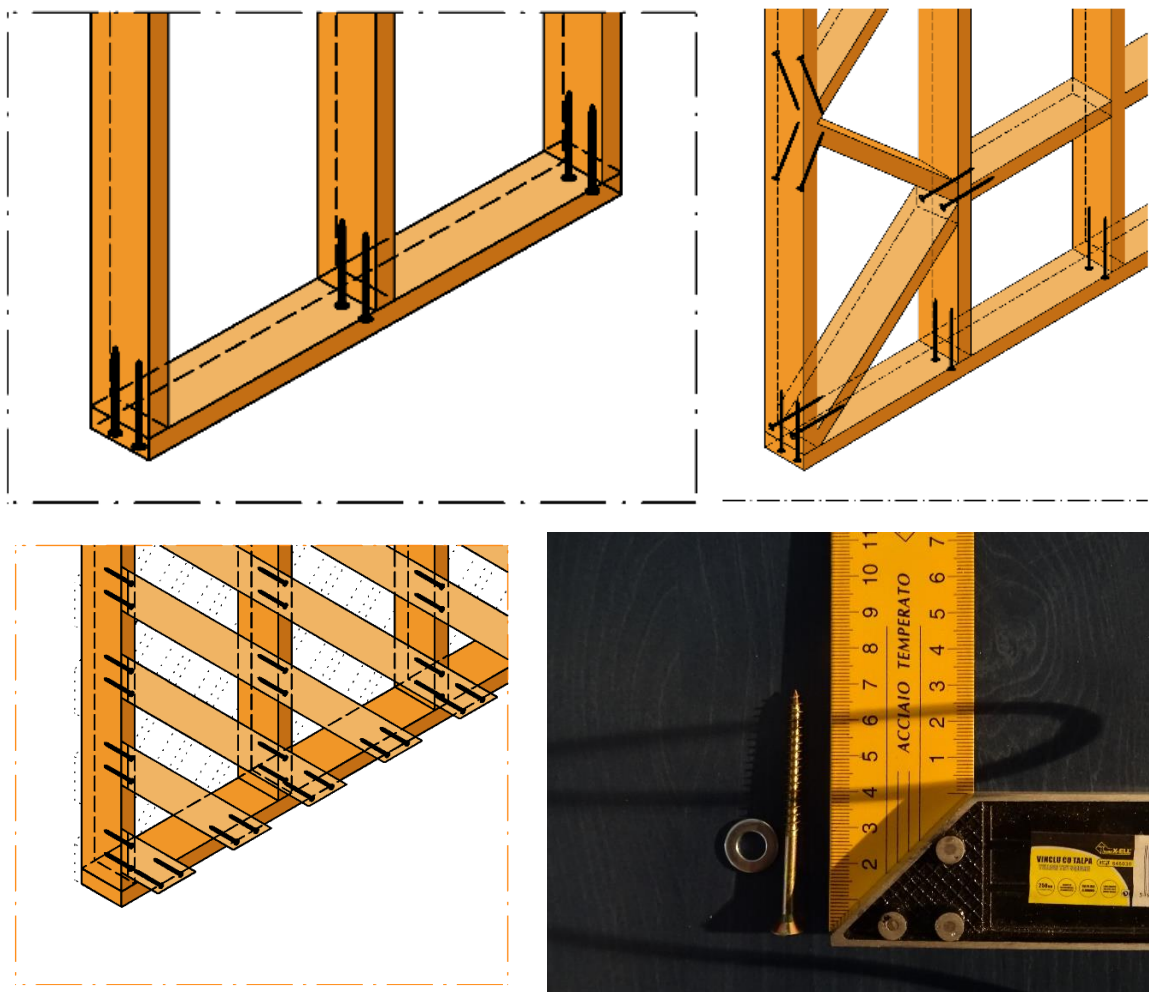
Fig. 18 – Îmbinări recomandate între elemente și tip de șurub (5x70 mm) cu șaibă
