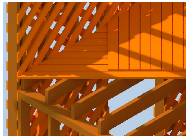
Fig. 22 – Peste grinzile de planșeu se pot monta scânduri de 2.5 cm grosime pe doua direcții, la unghi de 45° față de grinzile de planșeu, sau, cherestea de 5 cm perpendicular pe grinzi
