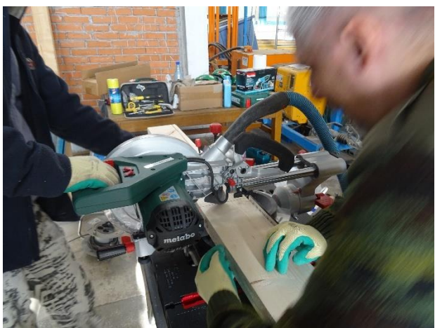
Fig. 26: Debitare elemente din lemn cu fierăstraul circular
