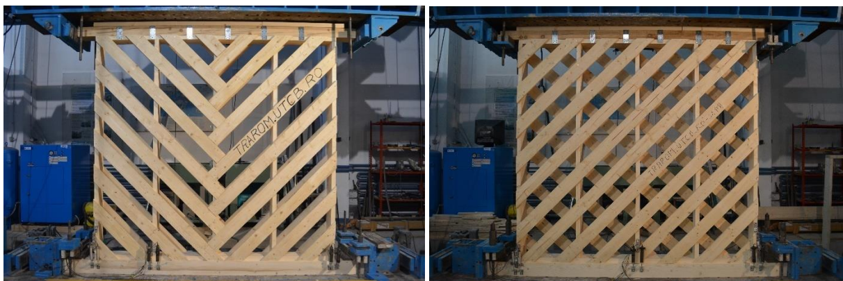
Fig. 28: Specimenul S1 (stânga) și specimenul S2 (dreapta)
