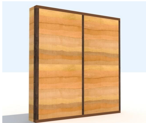
Fig. 24: Cadrul din lemn cu pământul compactat
